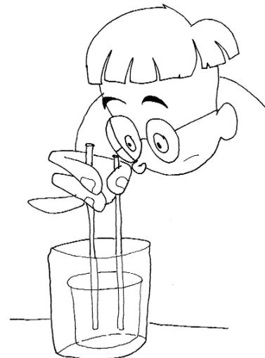
**Desarrollo:** Coloque dos tubos de vidrio de diferente diámetro en un recipiente con agua ligeramente colorada para facilitar la observación. Observará que la columna de líquido es más alta en el tubo de menor diámetro.
